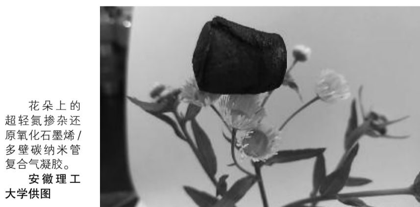
花朵上的超轻氮掺杂还原氧化石墨/多壁碳纳米管复合气凝胶
